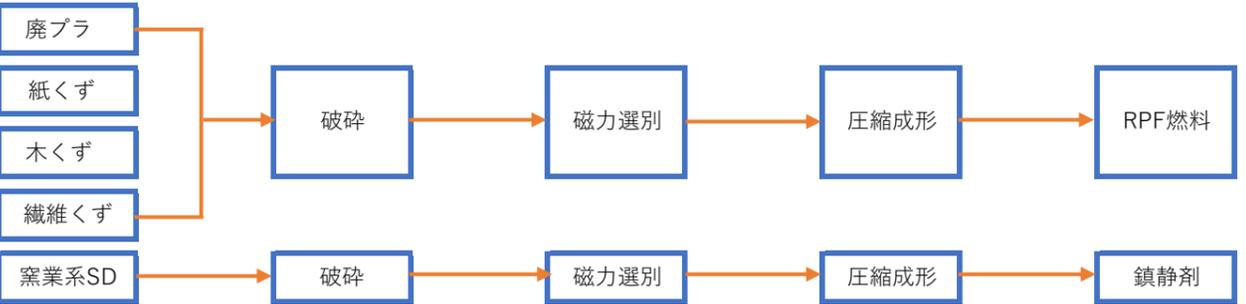
⑤ 破碎分離施設フロー図 [写真を見る](#)
