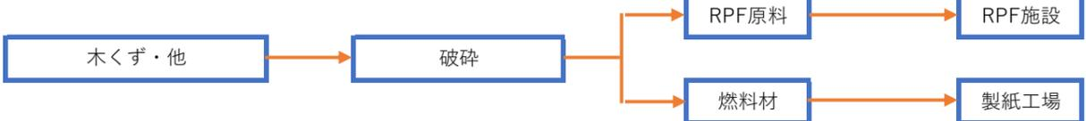
③ 第二破碎施設フロー図 [写真を見る](#)
